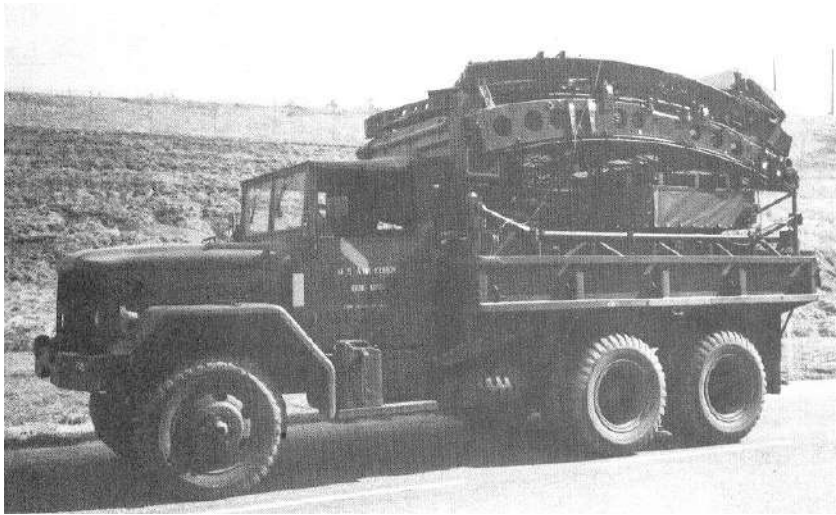
Fig. 1 Antena sobre camión M-54
